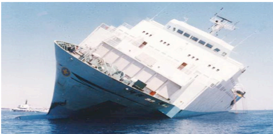
8. számú kép: A vezérlőrendszer hibájából oldalára dőlt komphajó (Ciprus déli partjai, 1980. június 07.) 348
